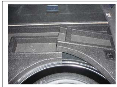
Schnitt durchs Styropor um die Bodenverkleidung zu verschieben
