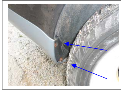
Demontage Stoßfänger rechts zwei Schrauben
