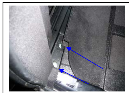
Befestigung des Innenstoßfängers links
