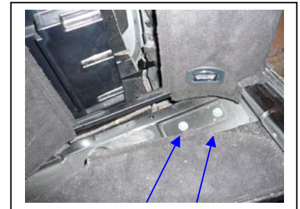
Befestigung des Innenstoßfängers rechts
