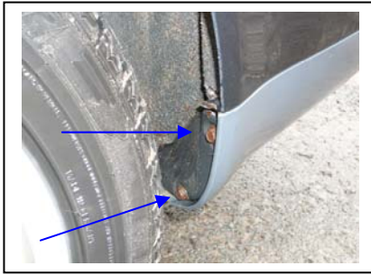
Demontage Stoßfänger links zwei Schrauben
