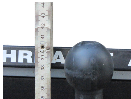
Stoßfänger muss für die Hängerkupplung ausgeschnitten werden
