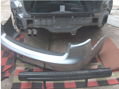
Träger für Stoßstange - ausgebaut
