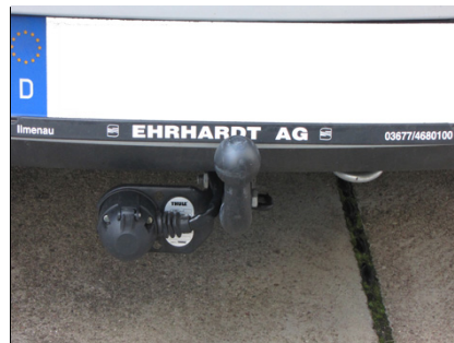
Stoßfänger muss für die Hängerkupplung ausgeschnitten werden
