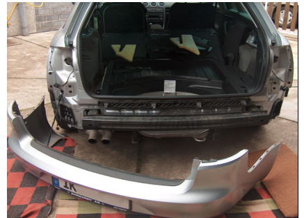
Stoßfänger vorsichtig ablegen Verkabelung für Rückfahrwarner sind nicht entfernt
