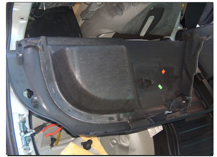
Seitenverkleidung nach vorsichtiges Lösen von 4 Spangen herausnehmen
